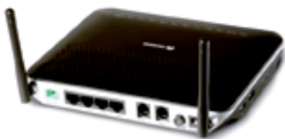
Abb. 2: ONT/ONU und Netzwerk-Router mit LAN-Anschlüssen und integriertem WLAN-Access Point
