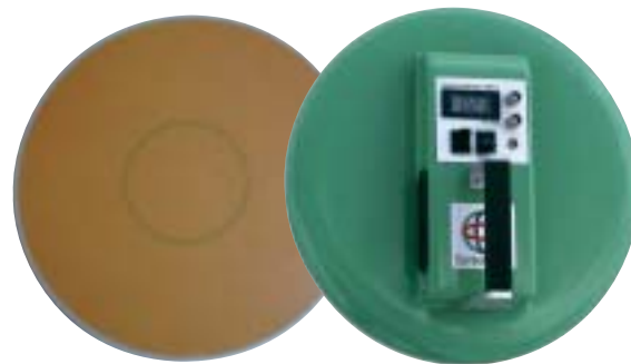
1 - TCO-Sonde, Vorderansicht mit innerer Mess-Sonde und äußerem Schirmring.
